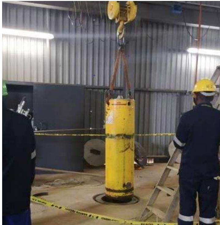
Figuur 12: Die vervoerhouer word oor SAFARI-1 stoorpyp geplaas in die TPS
