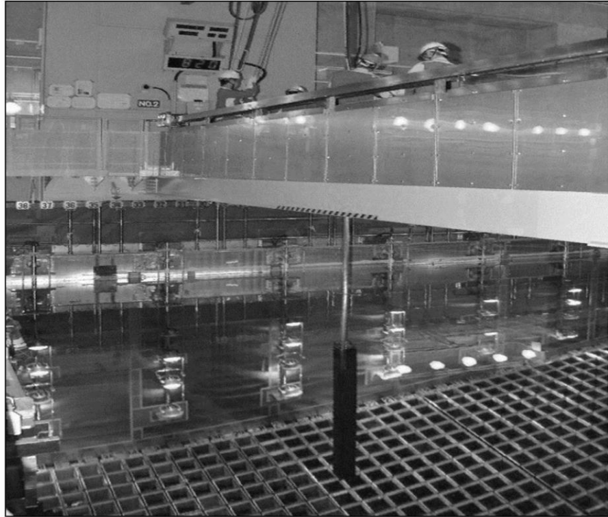
Umfanekiso 22: I-assembly yamafutha isiwa elugcinweni kwidama lamafutha asetyenzisiweyo elifana nelaseKoeberg
